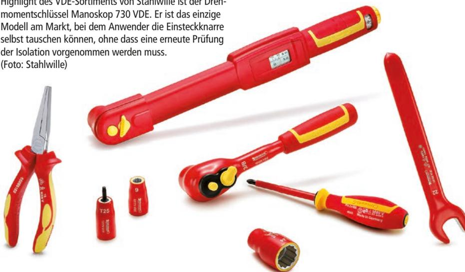
Die von Anwendern geschätzten Feinzahnknarren werden von Stahlwille VDE-geprüft mit 3/8" Antrieb angeboten. Mit 80 Zähnen generieren sie einen besonders kleinen Arbeitswinkel von nur 4,5 Grad. Deshalb ist der Einsatz auch auf engstem Raum möglich. Der spezielle Verriegelungsmechanismus macht diese Knarren besonders sicher: Erst der Druck auf den Quick-Release-Knopf löst das Einsteckwerkzeug, welches dann gewechselt werden kann.
