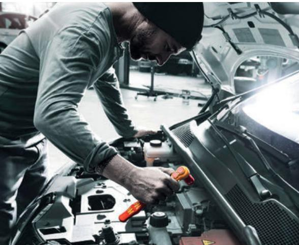
Die Zyklop VDE-Knarre von Wera sorgt auch in engen Räumen für feste Verbindungen und ist für sicheres Arbeiten bei Spannungen von bis zu 1.000 Volt zugelassen.
