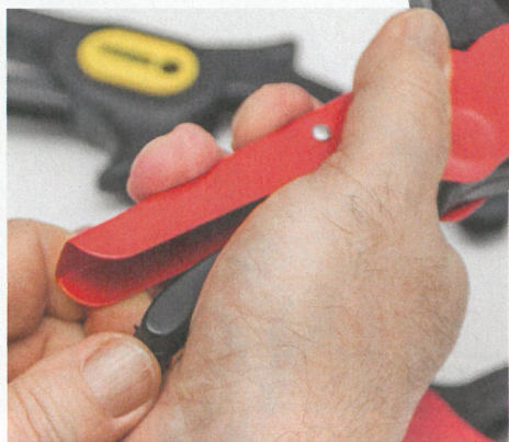
- KLEMMGEFAHR: Diese Noname-Zange schließt die Griffe viel zu weit.
