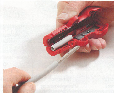
+ SAUBER: Der Mantel wird glatt abgetrennt ( NWS ).
