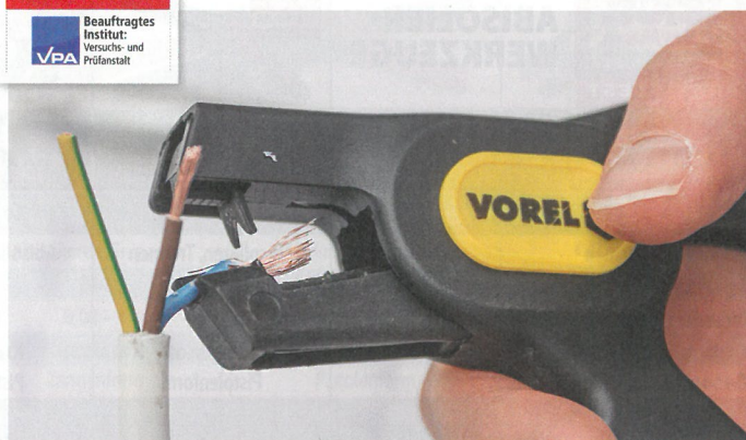
- QUETSCHUNG: Das Zugmesser in der Vorel-Zange schabt stark am Führungskörper und beschädigt die Adern.
